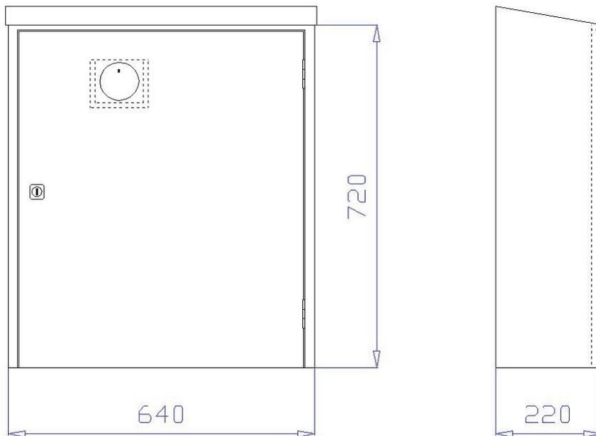
Aufputzschrank Bauart C 640 x 720 x 220 mm (Breite x Höhe x Tiefe) mit schrägem Dach, an drei Seiten überstehend, zur Aufnahme von zwei 6-kg- oder 12-kg-Handfeuerlöschern. Aus 1 mm verzinktem Stahlblech gekantet und verschweißt, frontseitige Stöße verschweißt und verschliffen. Belüftung über Türspalt. Montagebohrungen in der Rückwand. Endlackiert in Rot (RAL 3001).
